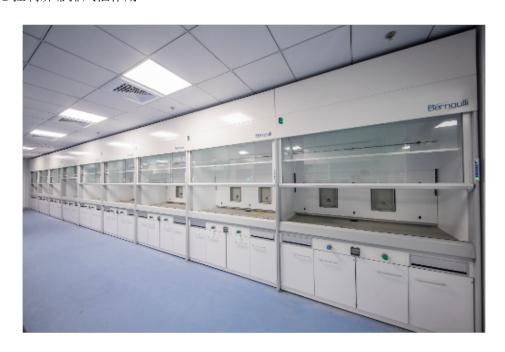
排风柜是实验室中常用的一种局部排风设备,种类繁多,由于其结构不同,使用的条件不同,其排风效果也不相同。排风柜的性能好环,主要取决于通过排风柜空气移动的速度。实验室排风是实验室设计中不可缺少的一个组成部分。为了使实验室工作人员不吸入或咽入一些有毒的、可致病的或毒性不明的化学物质和有机体、实验室中应有良好的排风。为阻止一些蒸气、气体和微粒(煤烟、烟露、灰尘和气悬体)的吸收,污染物质须用排风柜、排风罩或局部排风的方法除去。湖南LCD控制屏幕排风柜作用排风柜是实验室的安全装备,对保护科研人员的生命安全、提供舒适工作环境起到关键作用。
