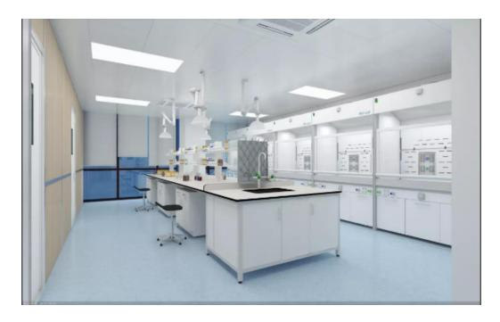
实验室建设中排风柜的使用率很高,如何选择合适,合理的排风柜安装位置,需要根据实验内容来选择排风柜的类型,材质、形状等,排风都要考虑。当使用有机物或其他特殊试剂实验时,要充分考虑其控制风速。热源:当使用带热源的设备时,其热量超过2000大卡/小时时要考虑排出热量所需的排风量从而确定风机的功率。有放射性物质或过氯酸等实验时:要选用专业用的排风柜,其面风速必须设定大于0.5m/s□使用大型设备进行实验时:要考虑内部的有效尺寸,为排风留出必要的空间。
